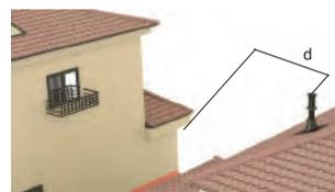
**D** Par rapport à un angle rentrant, zone d'interdiction avec un mur adjacent contigu à un ouvrant
