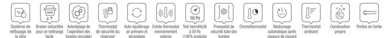
Système de nettoyage de la vitre | Brasier extractible pour un nettoyage facile | Autorégulation de l'aspiration des fumées (encoder) | Thermostat de sécurité du réservoir | Auto-équilibre air primaire et secondaire | Entrée thermostat environnement externe | Test hermétique à 50 Pa (100% produits) | Pressostat de sécurité tube des fumées | Chronothermostat | Réallumage automatique après coupure de courant | Thermostat ambiant | Combustion propre | Portes en fonte
