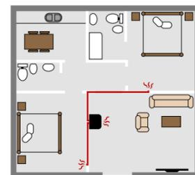
JUSQU'À 16 MÈTRES (8 m pour deux sorties) DE CANALISATION à travers 3 ventilateurs indépendants programmables avec 4 plages horaires
