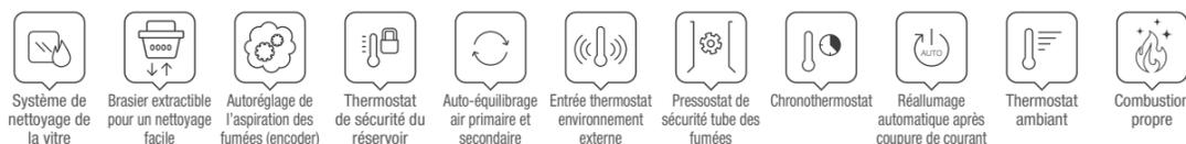
Système de nettoyage de la vitre | Brasier extractible pour un nettoyage facile | Autorégulation de l'aspiration des fumées (encoder) | Thermostat de sécurité du réservoir | Auto-équilibre air primaire et secondaire | Entrée thermostat environnement externe | Pressostat de sécurité tube des fumées | Chronothermostat | Réallumage automatique après coupure de courant | Thermostat ambiant | Combustion propre
