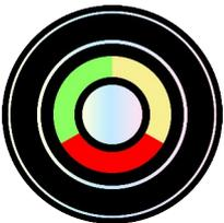
Voyant signalant l'état de fonctionnement : **vert** – fonctionnement correct de la chaudière, **jaune** – contrôle des réserves, **rouge** - alarme.
