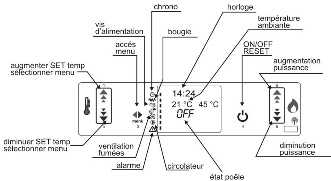
La figure ci-contre décrit la signification des signaleurs d'état sur la partie gauche de l'afficheur.
